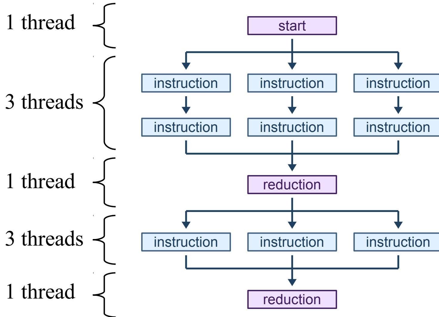
En las computadoras multi-core logra la mejor eficiencia cuando cada core ejecuta sólo un thread.
