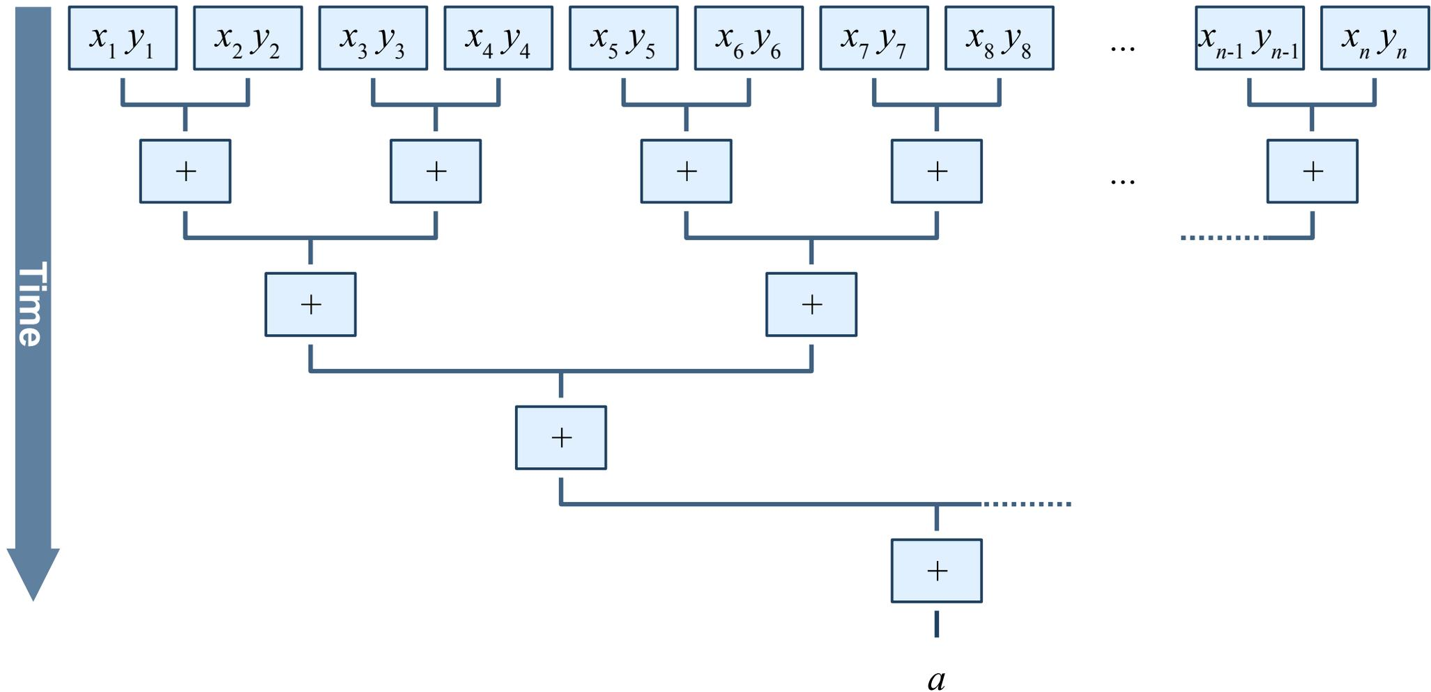
En este caso se tiene una paralelización eficiente de la multiplicación de las entradas de los vectores, después se va reduciendo la eficiencia al dividir las operaciones de suma en pares.
