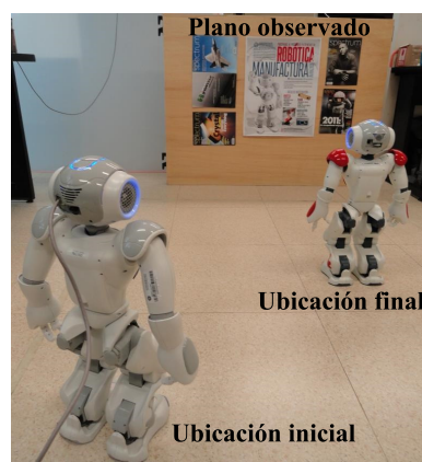
Figura 1. Tarea de posicionamiento de un robot humanoide mediante locomoción basada en estrategias de control visual.
