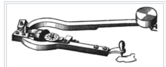
Un planímetro (1908) midiendo el área indicada por trazado de su perímetro.
